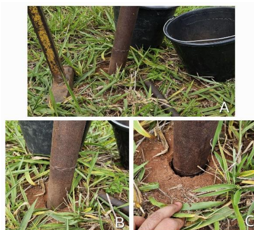
Figura 6: Materiais utilizados na coleta das análises de solo (A). Penetração do solo a 20 cm (B) e a 40 cm (C). Fonte: Arquivo pessoal (2023).
