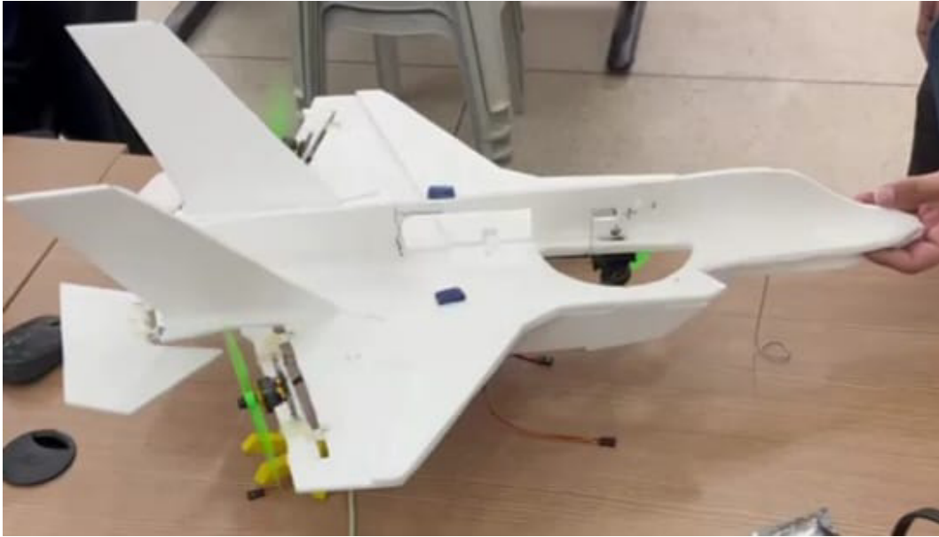
Figura 6.11 - Teste de verificação de funcionamento dos motores traseiros.
