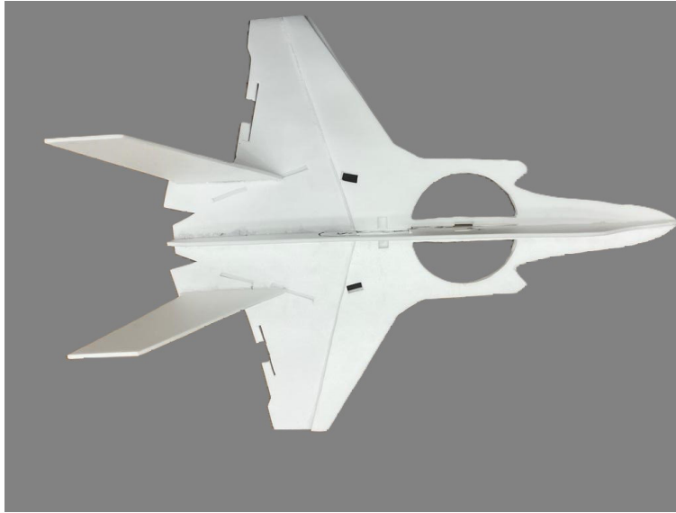
Figura 6.1 - Aeronave montada com Depron de 5mm.
