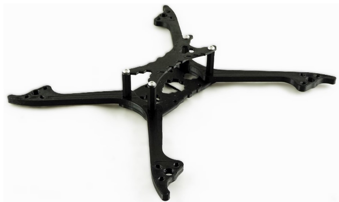
Figura 3.4 - Estrutura Impressa com Filamento ABS.
