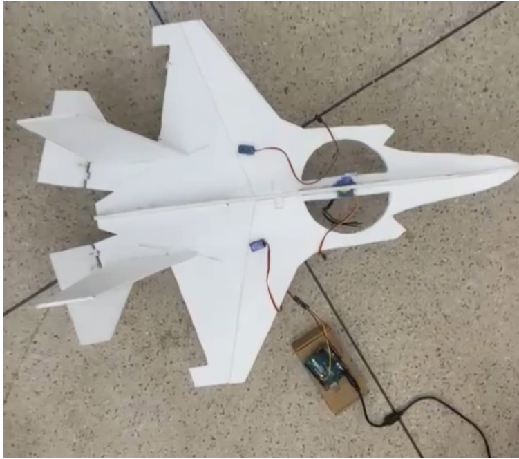
Figura 6.4 - Teste das superfícies de controle.
