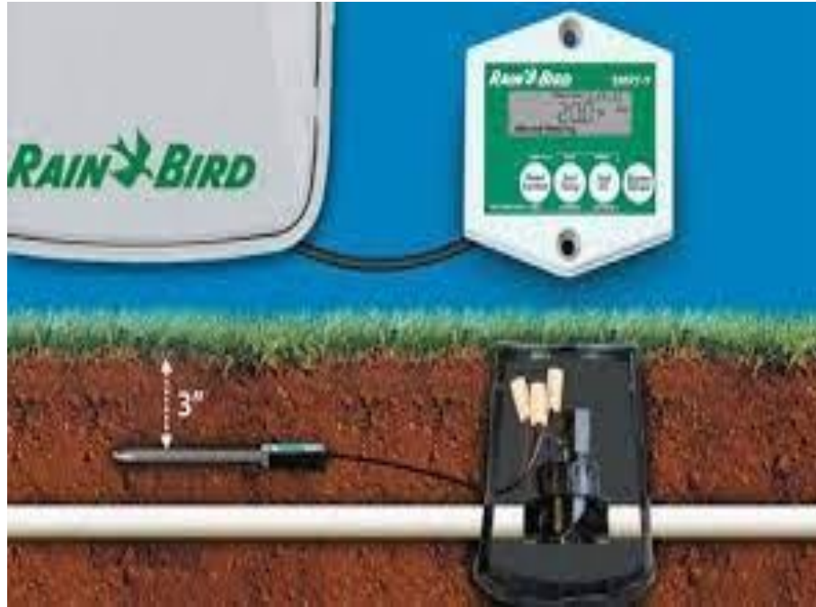
Figura 2.19. Irrigação automatizada com sensor de umidade Fonte: Sergieieva (2022).
