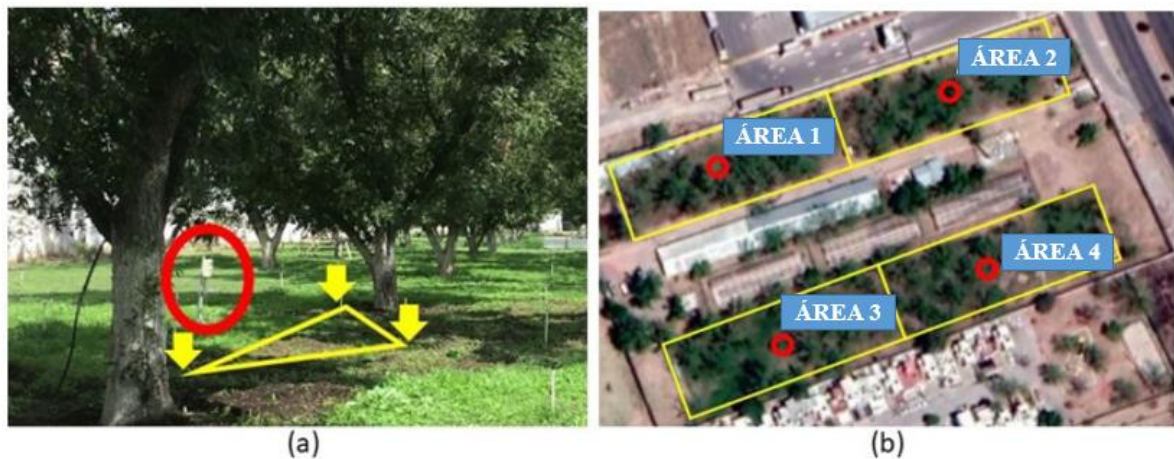
Figura 2.20. Campo experimental de cultivo de noz-pecã com as localizações dos nós sensores ilustrados com os círculos vermelhos: (a) Vista lateral da área 1; setas amarelas indicam os posicionamentos dos sensores. (b) Vista de satélite
