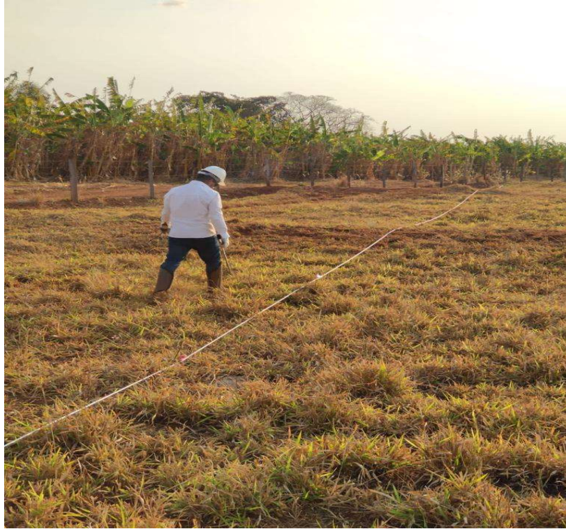
Figura 11 - Corda esticada para alinhamento dos eletrodos.
