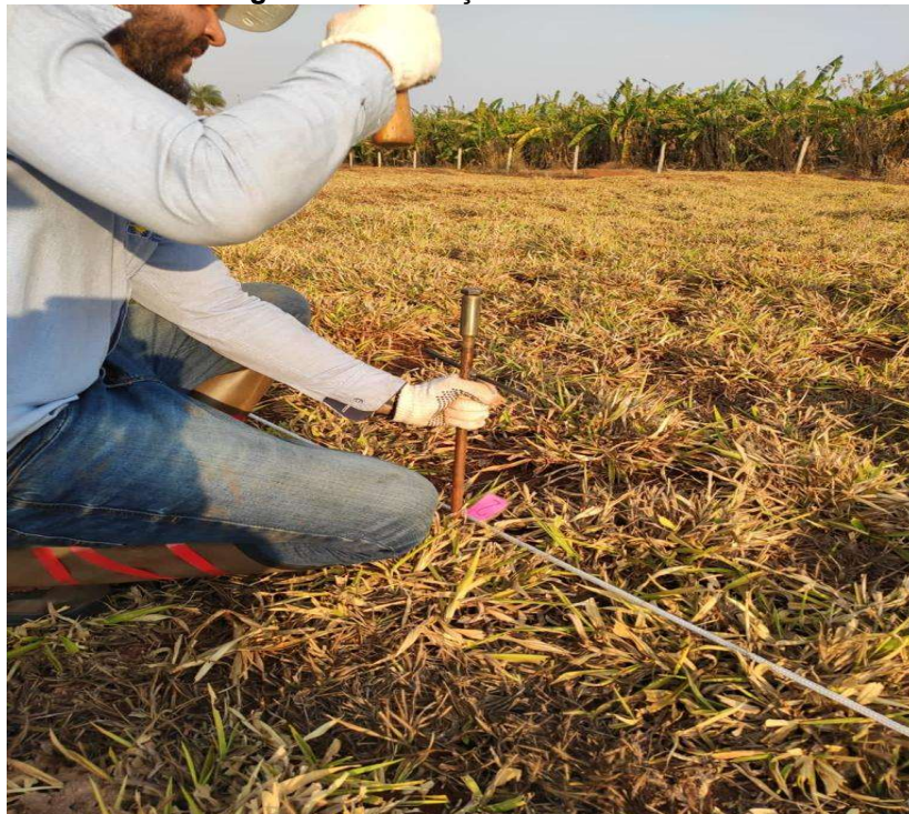
Figura 12 - Cravação dos eletrodos.
