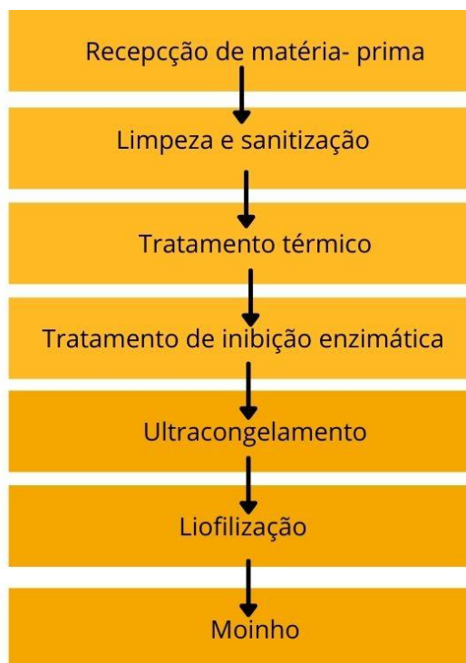
FIGURA 3 - Fluxograma de etapas para obtenção das farinhas de banana verde.
