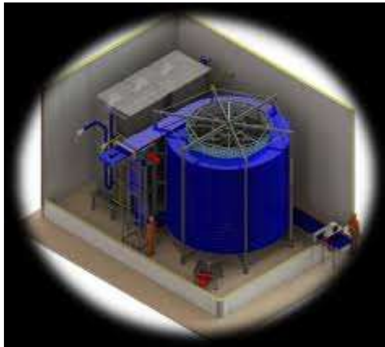
Figura 8: Representação de túnel em espiral [Fonte:GRAKO, 2013].
