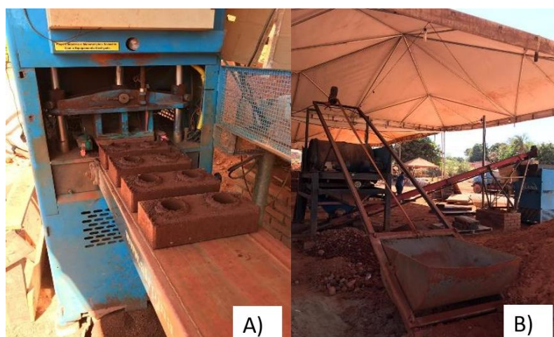
Figura 7: Equipamentos para fabricação dos tijolos de solo-cimento: (a) prensa hidráulica e (b) misturador e esteira mecânica
