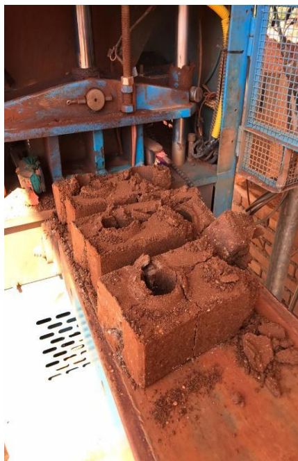
Figura 4: Tijolos de solo-cimento com 60% de substituição de solo por resíduo cerâmico.
