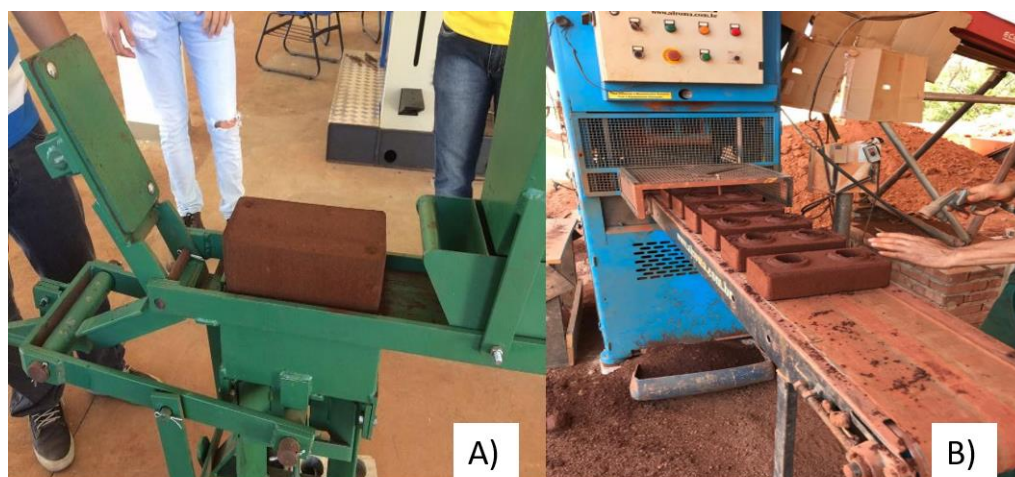
Figura 5: Formas de prensagem dos tijolos de solo-cimento (a) prensagem manual e (b) prensagem mecânica
