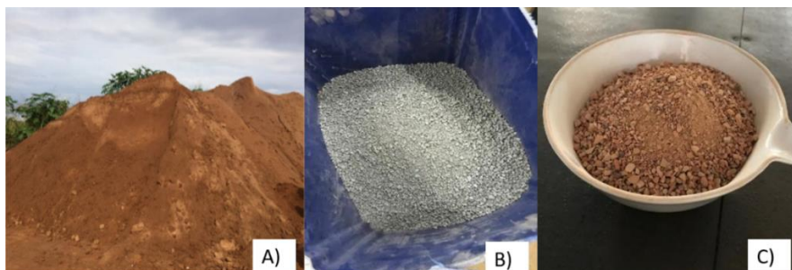
Figura 2: Resíduos de construção civil: (a) Resíduos mistos; (b) Resíduos de concreto; (c) Resíduos cerâmicos
